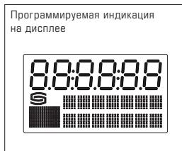
С помощью интерфейса EtherCAT можно запрограммировать индикацию на ЖК-дисплее. Если выбрана одна выходная величина, она отображается постоянно, при выборе нескольких величин они показываются поочередно.
