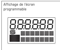
L'écran LCD peut être programmé via l'interface EtherCAT.
