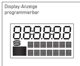
Über die EtherCAT-Schnittstelle kann die **LCD-Anzeige** programmiert werden. Wird nur eine Ausgangsgröße gewählt, erfolgt die Anzeige statisch, bei Mehrfachwahl zyklisch nacheinander.
