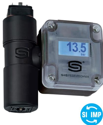
**PREMASGARD® LCD-SHD-Modbus** Modulo display per trasmettitore di pressione differenziale attivi con connettore EN 175301-803-A, per uscita attiva (0-10V) verso Modbus (RTU)
